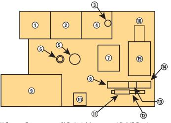
12) A/C Condenser 1) Storage Box 6) Swivel Joint and DEF Tank 7) Main Control Valve 13) Air Aftercooler 2) Fuel Tank 8) Oil Cooler 14) Radiator 3) Capsule Filter 9) Cab 15) Engine 4) Hydraulic Tank 10) Battery 16) Pumps 5) Swing Motor 11) Fuel Cooler
